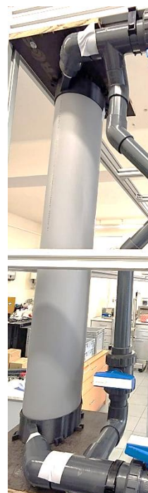
Obrázek 2. Fotografie hlavních částí funkčního vzorku: ventilátor CORMAK FN300SN (vlevo), vyměnitelná nabíjecí komora, zde obsahuje nástavce z PP (vpravo).
