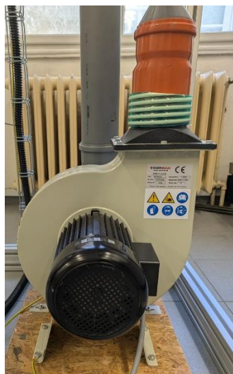
Obrázek 2. Fotografie hlavních částí funkčního vzorku: ventilátor CORMAK FN300SN (vlevo), vyměnitelná nabíjecí komora, zde obsahuje nástavce z PP (vpravo).
