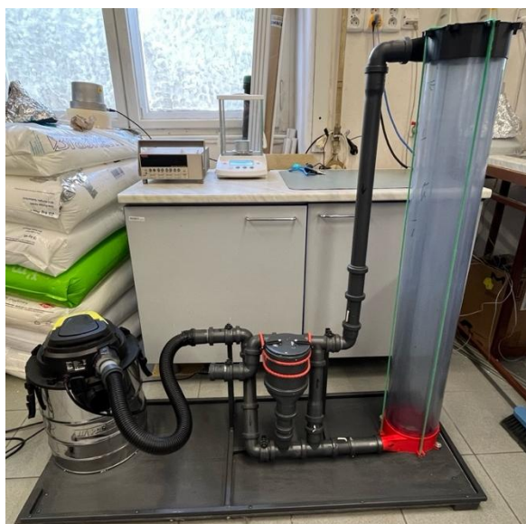
Obrázek 1. Fotografie (vlevo) a schéma (vpravo) tribocyklonového laboratorního nabíjecího zařízení: 1) vysavač Parkside; 2) násypka vsádky; 3) ventil na obtoku; 4) ventil na přítoku; 5) ventil na odtoku; 6) nabíjecí komora.
