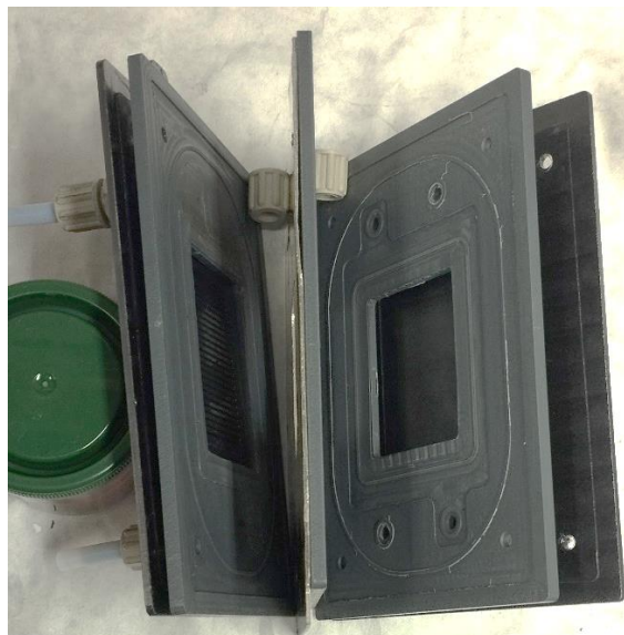
Obrázek 1: Schéma (vlevo) a fotografie (vpravo) tříkomorového laboratorního článku průtočné baterie zinek-vzduch.
