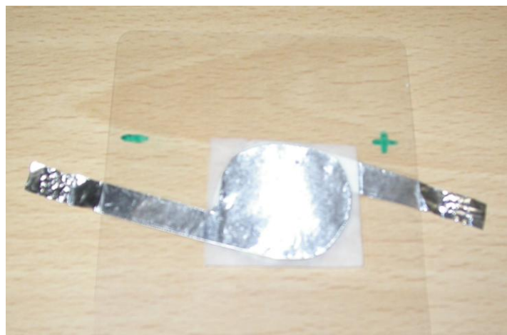
Obr. 1. Nanesená vrstva smíšených oxidů manganu na hliníkové fólii (vlevo) a sestavený superkapacitor zatavený ve fólii (vpravo).
