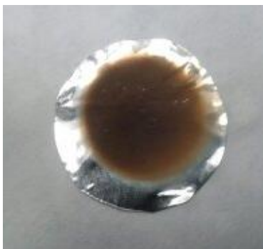
Obr. 1. Nanesená vrstva smíšených oxidů manganu na hliníkové fólii (vlevo) a sestavený superkapacitor zatavený ve fólii (vpravo).
